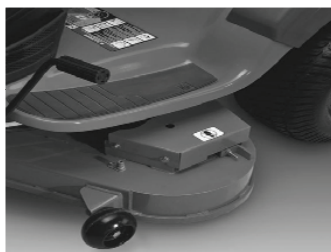
Coque d'unité de coupe estampée ci-dessous, NON renforcée
